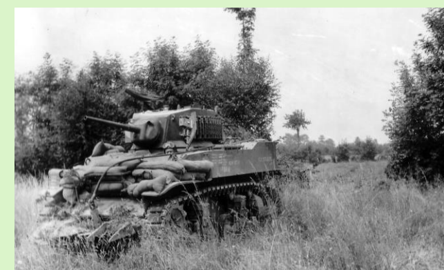
Char léger équipé du système de franchissement Culin dans le secteur de Balleroy. © US National Archives.
